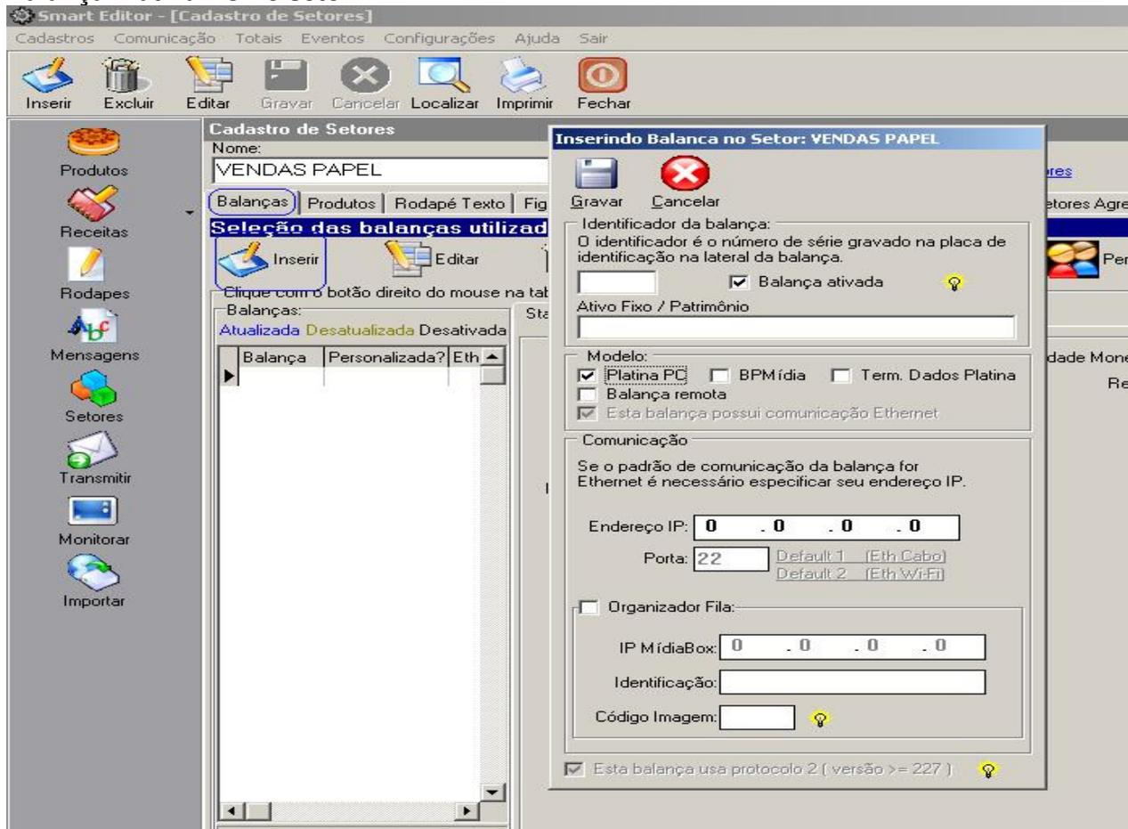
Na tela de Setores, na guia 'Balanças', clique no botão 'Inserir' na barra de manipulação dos registros dos cadastros que se encontra dentro da tela “Setores”, digite a identificação da balança, selecione a opção Platina PC, digite o endereço IP e clique em 'Gravar'.
