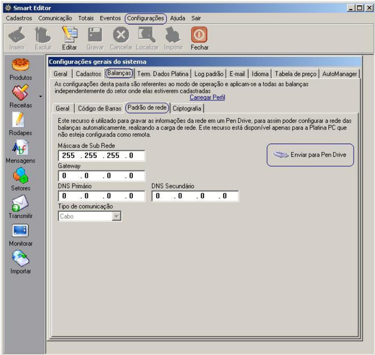
Padrão de rede disponibiliza a opção de configurar pelo Smart todos os parâmetros de rede e salvar no Pen Drive para que quando o dispositivo for conectado na balança assuma as novas configurações de rede. Após os dados inseridos e com o Pen Drive conectado ao computador clicar em 'Enviar para Pen Drive'.
