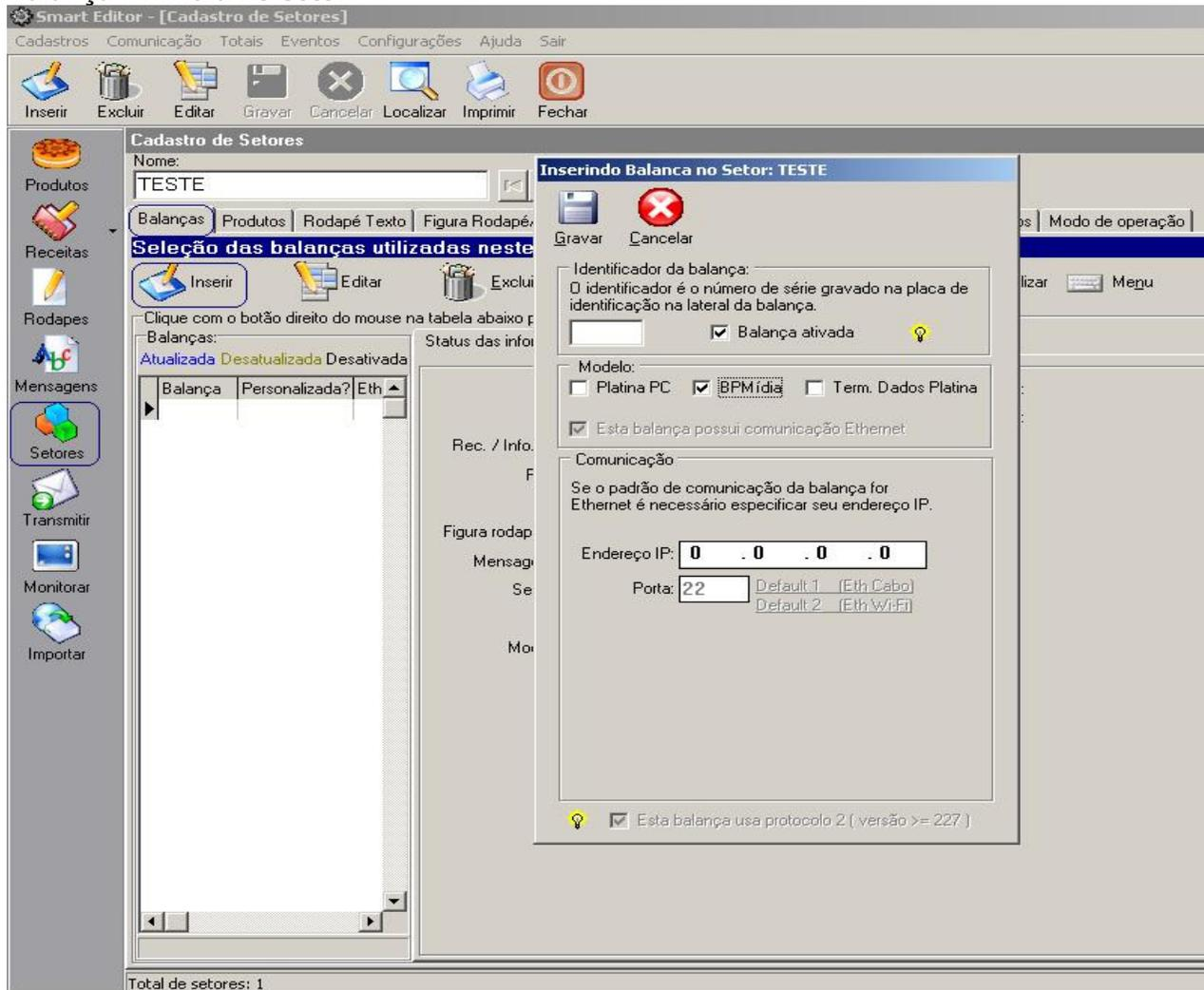
Na tela de Setores, na guia 'Balanças', clique no botão 'Inserir' na barra de manipulação dos registros dos cadastros que se encontra dentro da tela "Setores", digite a identificação da balança, selecione a opção BPMídia, informe o endereço IP e clique em 'Gravar'.
